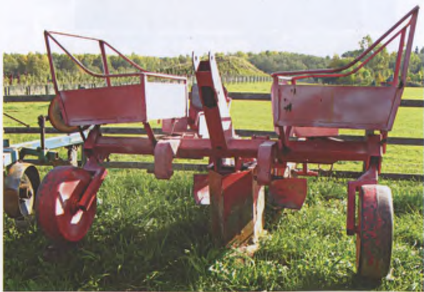
Рис. 41. Посадочная машина для высадки саженцев с комом
