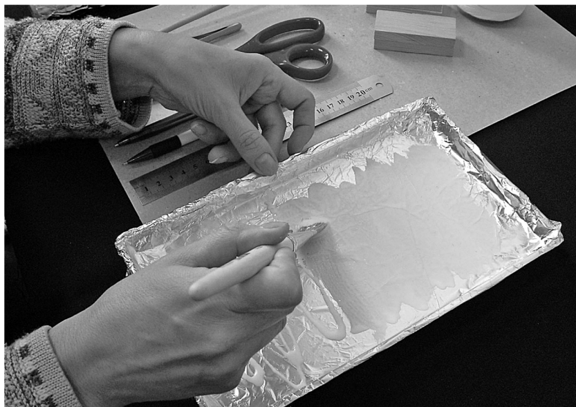
Рис. 24. Налейте и распределите клей слоем 1–2 мм по дну лотка
